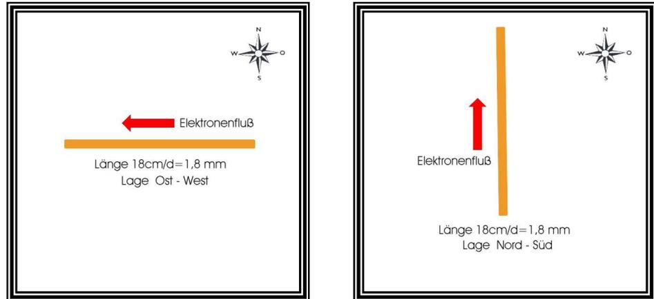
Liegt der Leiter gegen den Fluß des Erdmagnetfeldes (von Ost nach West), so bewegen sich bei einem Kupferleiter mit 1,8 mm Durchmesser und 180 mm Länge ca. 500000 Elektronen. Bei einem Eisenleiter mit 1,8 mm Durchmesser und 180 mm Länge bewegen sich nur ca. 3000 Elektronen. Der Elektronenfluß erfolgt von Ost nach West.
